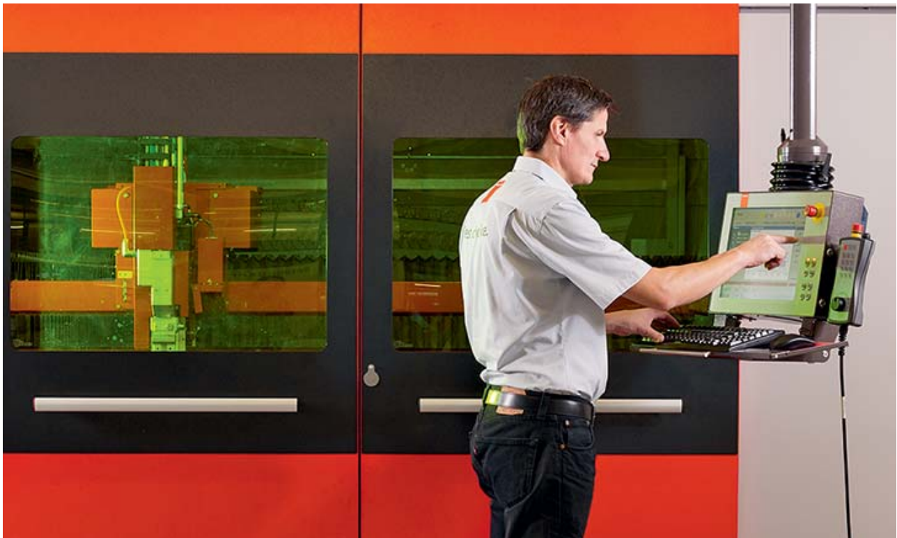
Bild 15: Eine Lasereinrichtung in einem Produktionsraum ist mit einem komplett abschirmenden Schutzgehäuse zu versehen.
