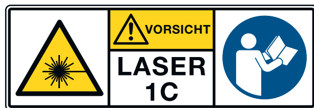
Bild 7: Kennzeichnung für Laser der Klasse 1C. Alternativ kann auch die Kennzeichnung wie in Kapitel 6.2 verwendet werden.
